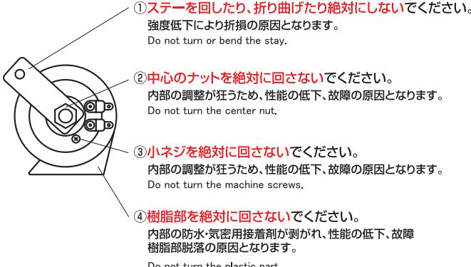
●直接水のかかる場所を避け、ホーンの開口部が必ず下になるように取り付けてください。
