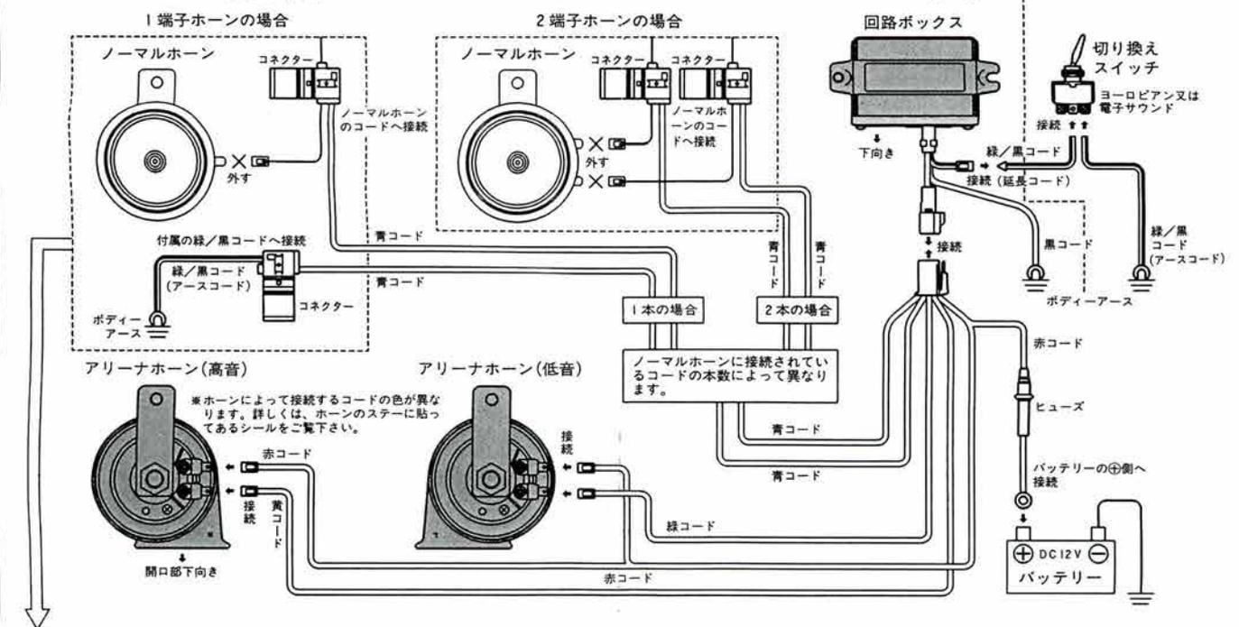
注1) 1端子ノーマルホーン2ヶが下図のように配線されている時は、コード(A)、(B)のように1ヶの端子に2本のコードが接続されています。この場合、青コードの1本を(A)又は(B)に接続し、もう1本の青コードを緑/黒コードでボディアースして下さい。
