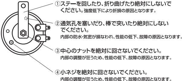
●直接水のかかる場所、高温となる場所、振動の激しい場所を避け、剛性の高い鉄シャーシ部の既存穴を利用し、取付部以外が他の部品と接触しないように取り付けてください。正常に鳴らなくなったり、故障の原因となります。
